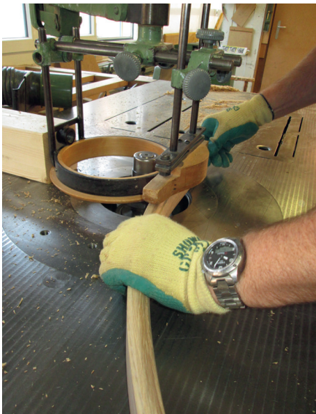
Für die konventionelle Fertigungsweise mussten einige Schablonen erstellt werden.
